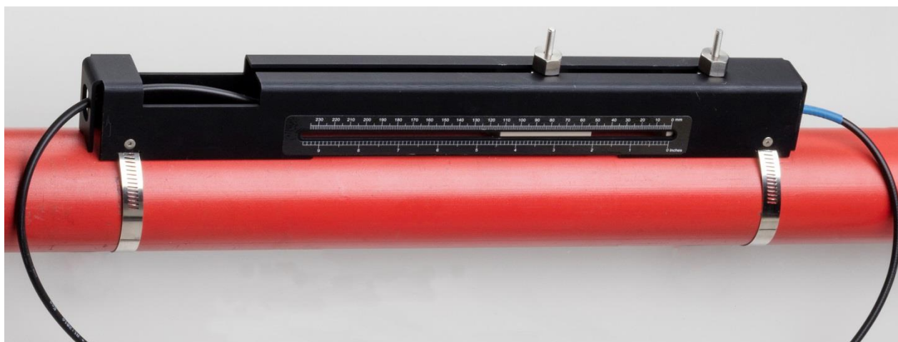
Figure 17 Abaisser les transducteurs sur la canalisation
