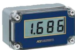
**Le Modèle DM10** est un afficheur LCD qu'il est possible d'insérer et positionner partout dans la boucle de sortie 4-20 mA depuis le ST75. Il ne nécessite aucune alimentation électrique séparée puisqu'il dérive son courant électrique directement depuis la boucle 4-20 mA. Le DM10 est programmable par l'utilisateur jusqu'à  $\pm 1999$  digits et possède des caractères surdimensionnés de 25 mm de hauteur pour une lecture plus aisée. Spécifié NEMA 4X. Modèles certifiés FM et CSA en option.
