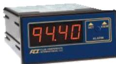
**Le Modèle DM15** est un appareil de grande précision alimenté en courant alternatif (CA) et monté sur panneau DIN 1/8. Il est muni d'un afficheur à diodes électroluminescentes (DEL) très brillantes de couleur rouge. Il se caractérise par un affichage numérique de  $\pm 9999$  digits programmable par l'utilisateur et accepte les signaux 4-20 mA ou 0-10 VCC provenant du ST75.
