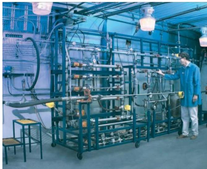
calibration NIST traçable à la pointe de la technologie. Les développements de produits FCI sont sujets à des tests rigoureux et à une validation d'intégrité de calibration utilisant des systèmes d'acquisition de données à grande vitesse et un équipement de calibration du débit de précision. Chaque débitmètre FCI est également testé de manière intensive, puis calibré en utilisant des gaz réels aux conditions du clients afin d'assurer leurs qualité et performances.
