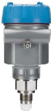
Le SLN700L-83 est un émetteur radar FMCW de 80 GHz pour la mesure en continu du niveau de liquides dans différentes conditions de traitement, en particulier dans les petits navires. L'excellente focalisation du faisceau peut fournir une mesure précise et fiable du processus de base aux liquides légèrement corrosifs, en particulier pour les petits récipients.
