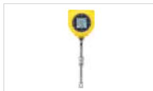
**1 capteur / insertion** Débitmètre pour diamètre 2 1/2" [64 mm] et étalonnage 0.25 SFPS à 1000 SFPS [0,07NMPS à 305 NMPS].
